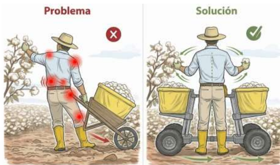
Figura B6. Carga unilateral vs distribución simétrica de cargas durante la recolección manual de algodón
