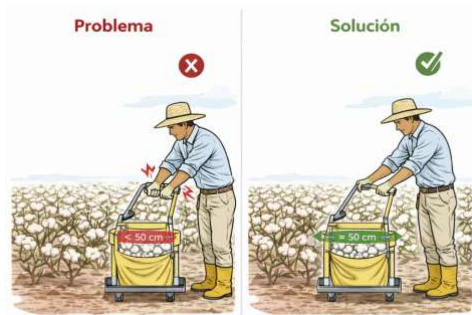
Figura A3. Espacio de trabajo insuficiente en comparación con espacio adecuado para la manipulación del dispositivo durante la recolección de algodón
